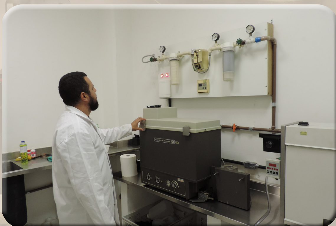
Laboratório de revelação, Victor mostra processadora Kodak Prostar II, que produz os microfimes.
